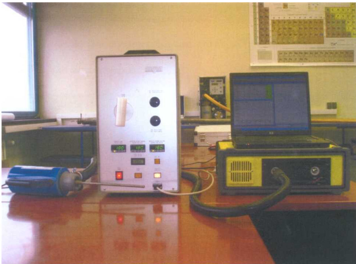
Slika 1: Korištena mjerna oprema - Gasmeter DX 400 sa pripadajućim grijanim modulom i sondom, te računalom sa upravljačkim software-om - Calcmet.
